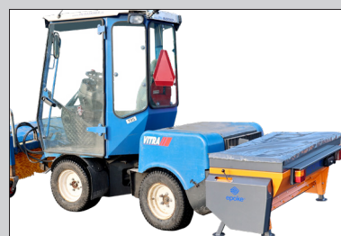
PM-serien egner sig til montage på kompakttraktorer og mindre bærere.
