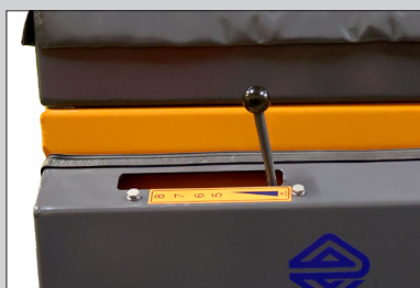
Spredemængden reguleres manuelt ved hjælp af håndtaget på spredersens side.
