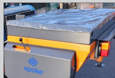
Presenning beskytter spredematerialerne mod nedbør.
