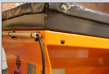
Overbeholder til øget materialekapacitet findes i to forskellige størrelser.
